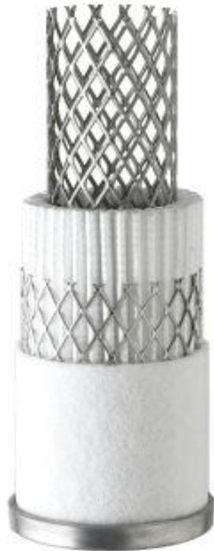
오일제거필터-U grade 파티클제거 : 1um 오일제거 : 0.5 mg/m 3
